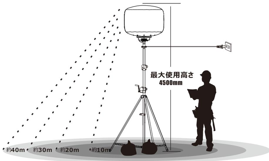
※最大の高さで使用する際は、三脚の脚に砂袋などの重しを置いてご使用ください。
