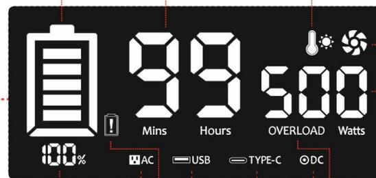
②バッテリー残量表示 ③残量低下通知 ⑥過負荷警告表示
