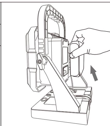
取り外し時：バッテリーバックの上にあるボタンを押しのまま引き上げてください
